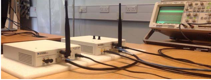
(d) MIMO cable hardware synchronization
