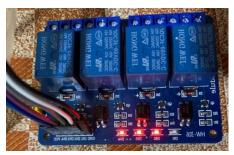
Fig 11. Relay Module (4 Channel).
