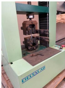
Fig. 3. Test Machine DELTALAB Serie EM550.
