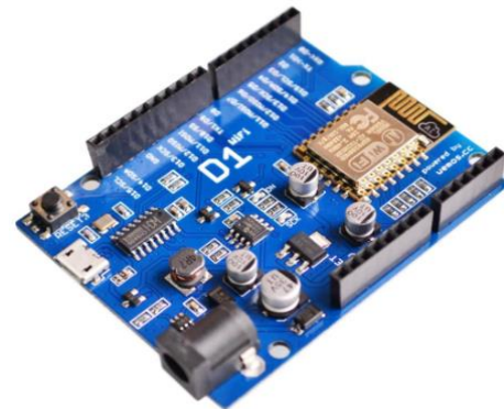
Fig. 7. Wemos D1 microcontroller.
