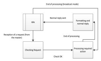
Fig. 10. Modbus Slave State Diagram
