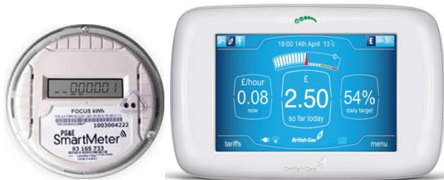
Fig. 1. a) Smart Meter b) Smart Meter Display Device
